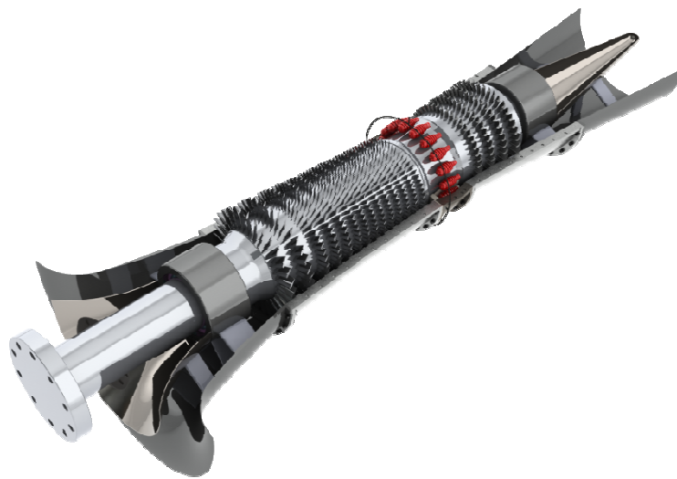
شکل ۶-۱۴: تصویر یک موتور جت توربوشفت زمینی با آرایش بخصوص محافظه احتراق
