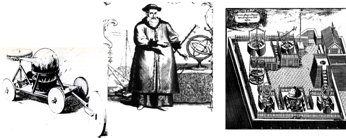
شکل ۱-۸: یک نمونه وسیله نقلیه ابتدایی با استفاده از توربین بخار
